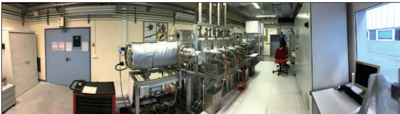
Fig. 2 Multilayer Laboratory 所有の大型 X 線ミラー (~1.2 m) 用多層膜成膜装置
