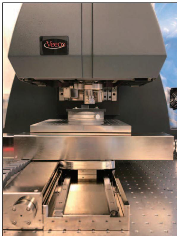
Fig. 12 Metrology Laboratory での小型全反射ミラーの計測風景
